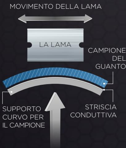
Lo standard riveduto EN 388:2016 per le attrezzature di protezione contro i rischi meccanici include il metodo internazionale di test ISO 13997. Questo metodo di test è ampiamente utilizzato nel settore tessile per avere una visione migliore dei livelli di protezione. Un campione di guanto viene testato con una lama a carico variabile in una macchina TDM (Tomo Dynamo Meter). La resistenza al taglio viene espressa come forza di taglio nella fessurazione in newton (N).
