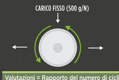
Utilizzando una lama circolare che si muove avanti e indietro e con un carico fisso di 500 grammi, la macchina per il Coup Test calcola il numero di cicli necessario per penetrare nel tessuto del campione.
